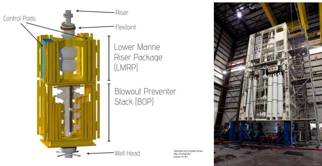
BOP-stack (skjematisk oversikt og montert BOP-stack)
