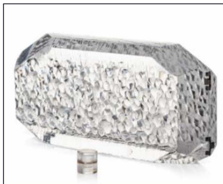
Figur 23 – Kvartskrystall brukt i en QD kvarstrykksensor
