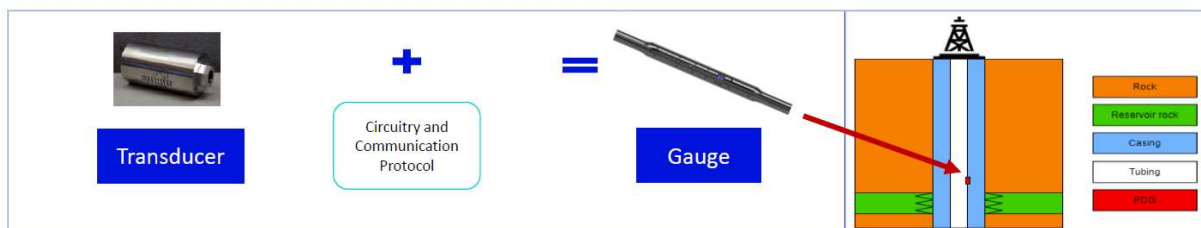
Figur 10 Plassering av en nedihullsmåler i en brønn 164
