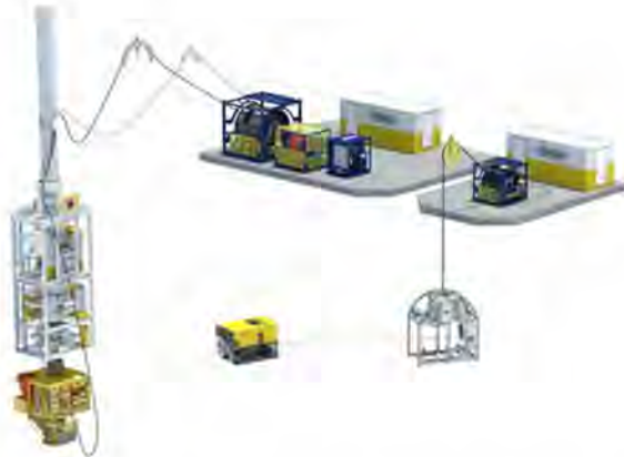
Figur 4: Tradisjonelt IWOCS koblet til en BOP og ventiltre. Til høyre er en ROV (OCEANEERING).
